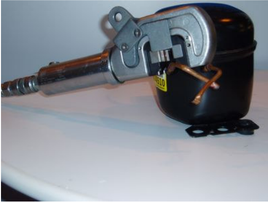
Billede 1: Afklippertang til demontering af kompressorer.
