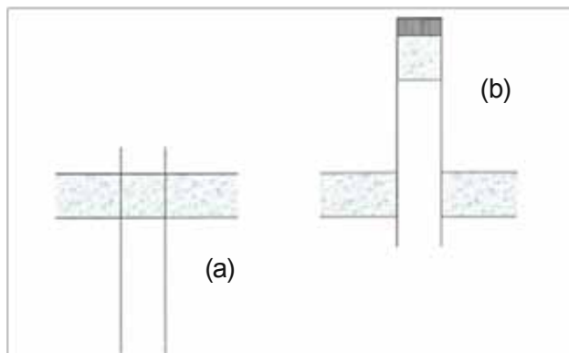
Fig. 7. En primitiv vandhenter til pejling af olie- og benzinudskiller. I olieudskillere, som virker efter hensigten, kan man tydeligt registrere en lagdeling mellem faserne olie/vand og vand/slam (b). I dårligt fungerende udskillere vil pejling med en vandhenter vise, at vandet har farve og konsistens som "gråt kørnemælk" (a). Årsagen kan være brug af højtryksrensere og/eller kemikalier.
