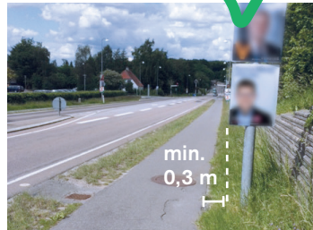
Lovlig ophængning - i rabat ved cykelsti intet højdekrav, når afstand 0,3 m til cyklistikant er overholdt.
