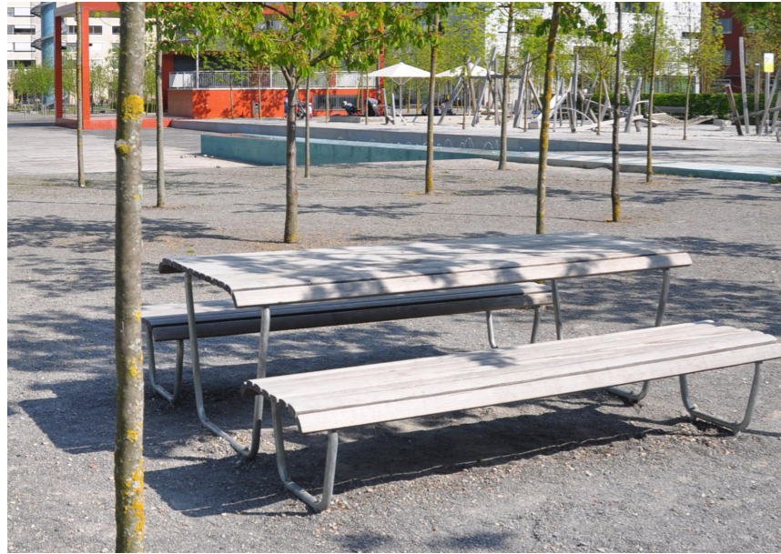
Bord- og bænkesæt med galvaniseret stål og trælameller.
