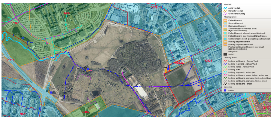
Figur 6: Kloakoplade i spildevandsplan 2021 - 2026 samt ledninger, bassiner og "Koldkær Bæk, tilløb fra Brendstrup"
