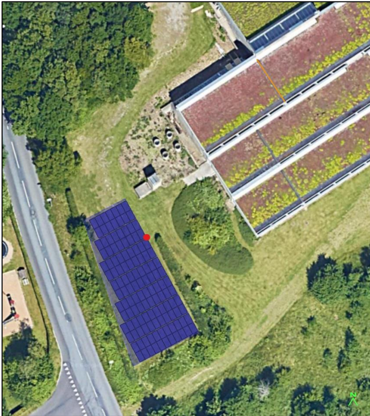
Figur 2: Placering af solceller i projektområdet. Placering af inverteren er vist med en rød cirkel.
