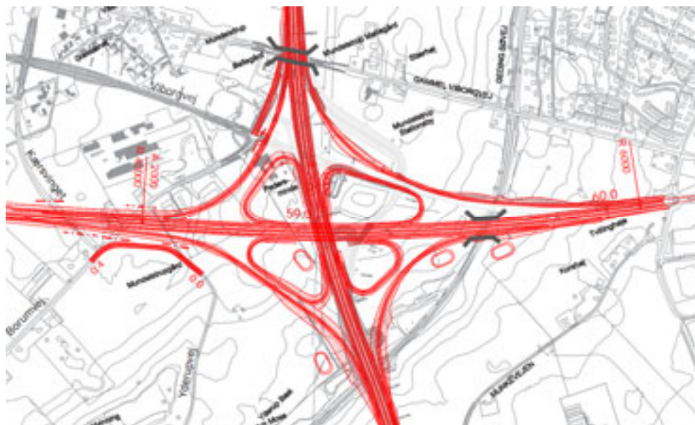
Figur 3.4 Skitse af sydlig variant for kløverblad ved E45 med udbygning af Viborgvej fra til Tilst Vestervej. Vejdirektoratet, 2012.
