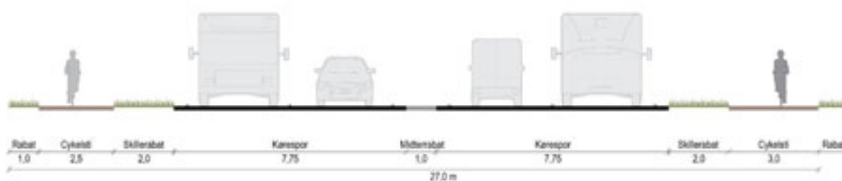
Figur 4.7 Alternativ med en smallere midterrabat på strækningen mellem Tilst Vestervej og Holmstrupgårdvej (set mod vest).
