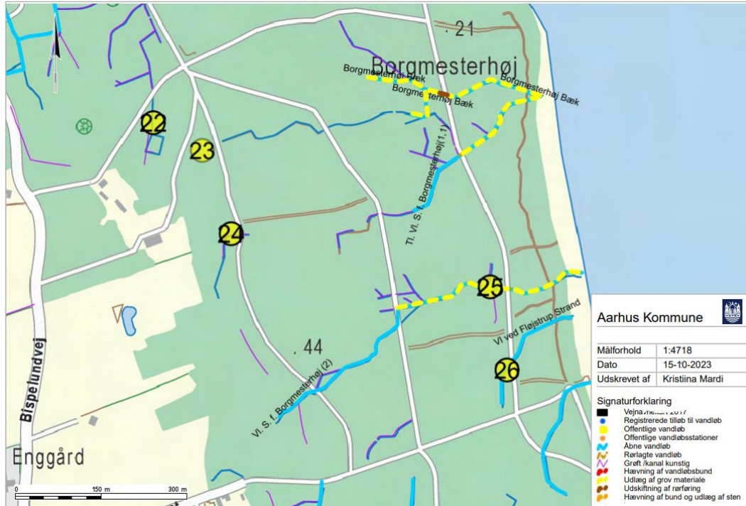
Figur 9. Oversigtskort over tiltag i og ved Borgmesterhøj Bæk. Gule stiplede linjer viser vandløbsstrækningen hvor der udlægges groft materiale.
