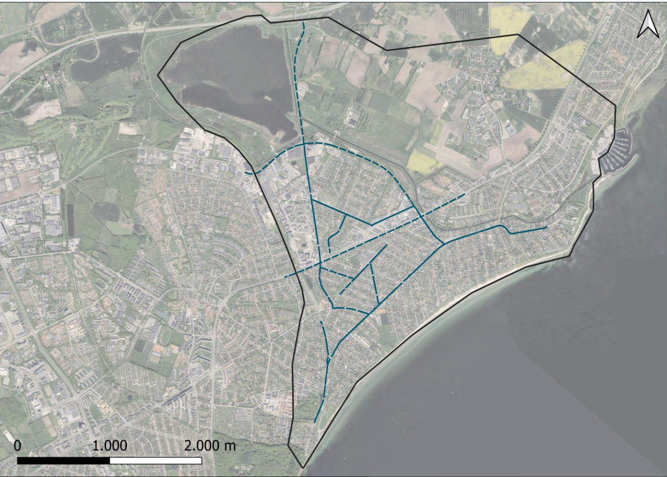
Skitsering af vejstr kninger hvor der potentielt kan etableres vejkassedr n, vist med bl  stiplede linjer.
