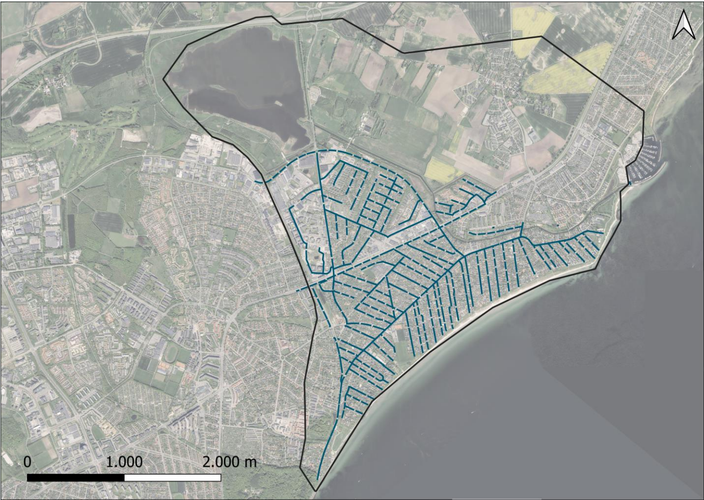
Skitsering af tracéer for horisontale drænledninger i projektområdet, vist med blå stiplede linjer. De horisontale drænledninger er skitseret i delområderne der er udfordret af højtstående grundvand.
