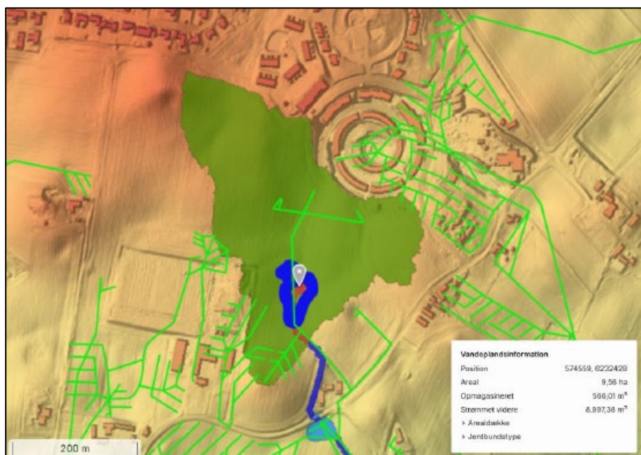
Figur 6 - Udklip fra ScalgoLive med placering af bassin 2.4, drænsystemer og opland til bassin 2.4
