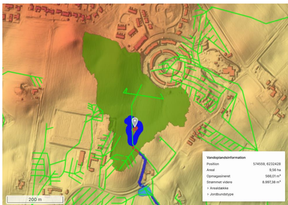
Figur 1 - Udklip fra ScalgoLive med placering af bassin 2.4, drænsystemer og opland til bassin 2.4
