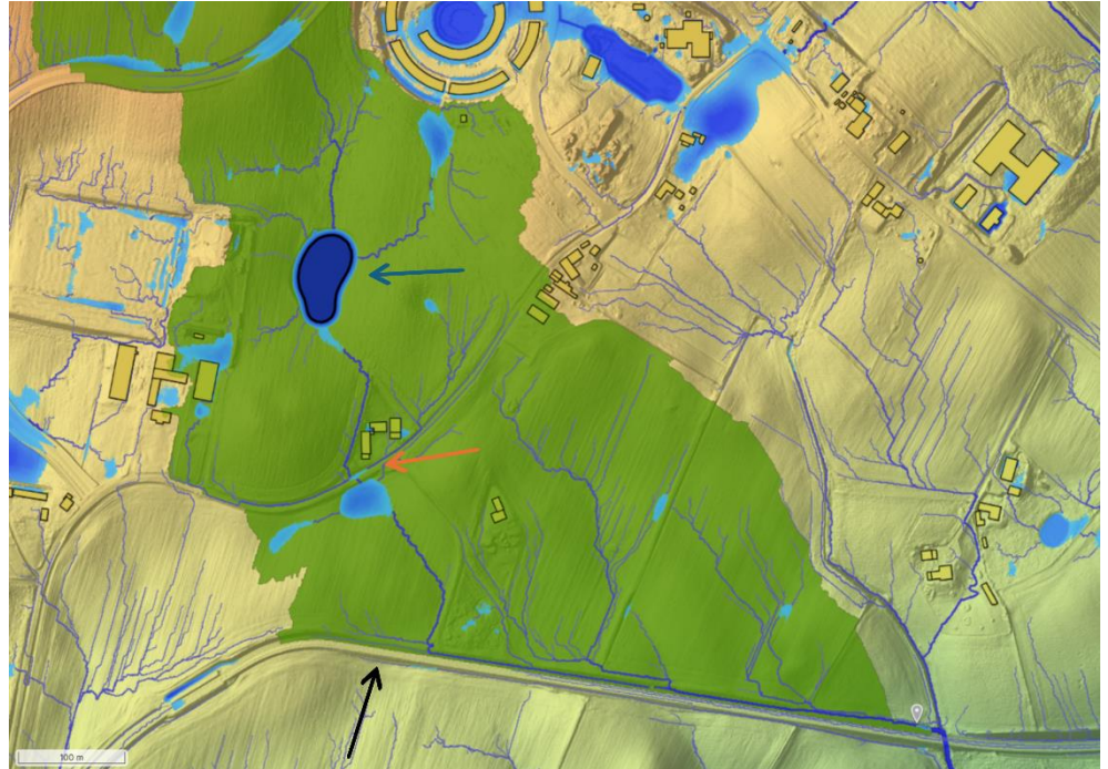
Figur 9-3 Strømningsveje for nødoverløb fra bassin 2.4. Strømningsveje er vist fra bassin 2.4 til Bueris Bæk. Blå pil angiver bassin 2.4, rød pil angiver krydsning med Elstedvej og sort pil angiver Letbanetracéet
