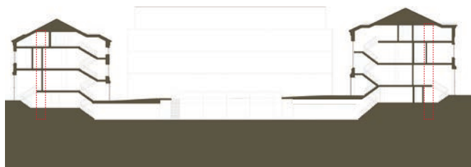
Principssnit i risalitter med nye døre og trappeforbindelser mod byen
