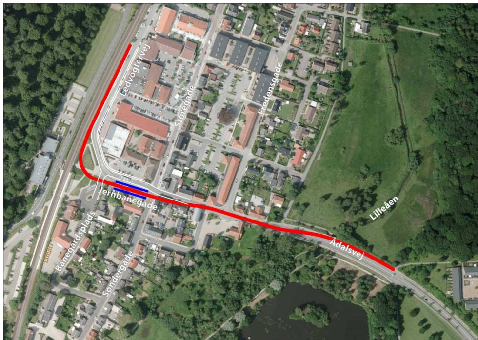
Figur 7 Forslag 1 med forlængelse til Hadsten. Standsningsstedet placeres på Jernbanegade og biltrafikken på Jernbanegade forlægges mod nord.
