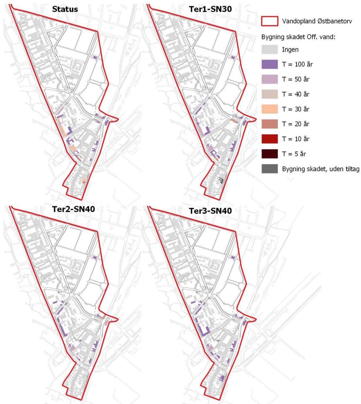
Figur 7-8. Laveste gentagelsesperiode hvor bygninger skades af vand fra offentlige arealer ved planscenarier for det sydlige delområde, øverst tv. Status, øverst th. Ter1-SN30, nederst tv. Ter2-SN40 og nederst th. Ter3-SN40. For den nordlige del er der de samme løsningstiltag i alle planscenarier og derfor samme resulterende skadede bygninger. Oversvømmelseskort findes i stort format i bilag A4, A5 og A6.
