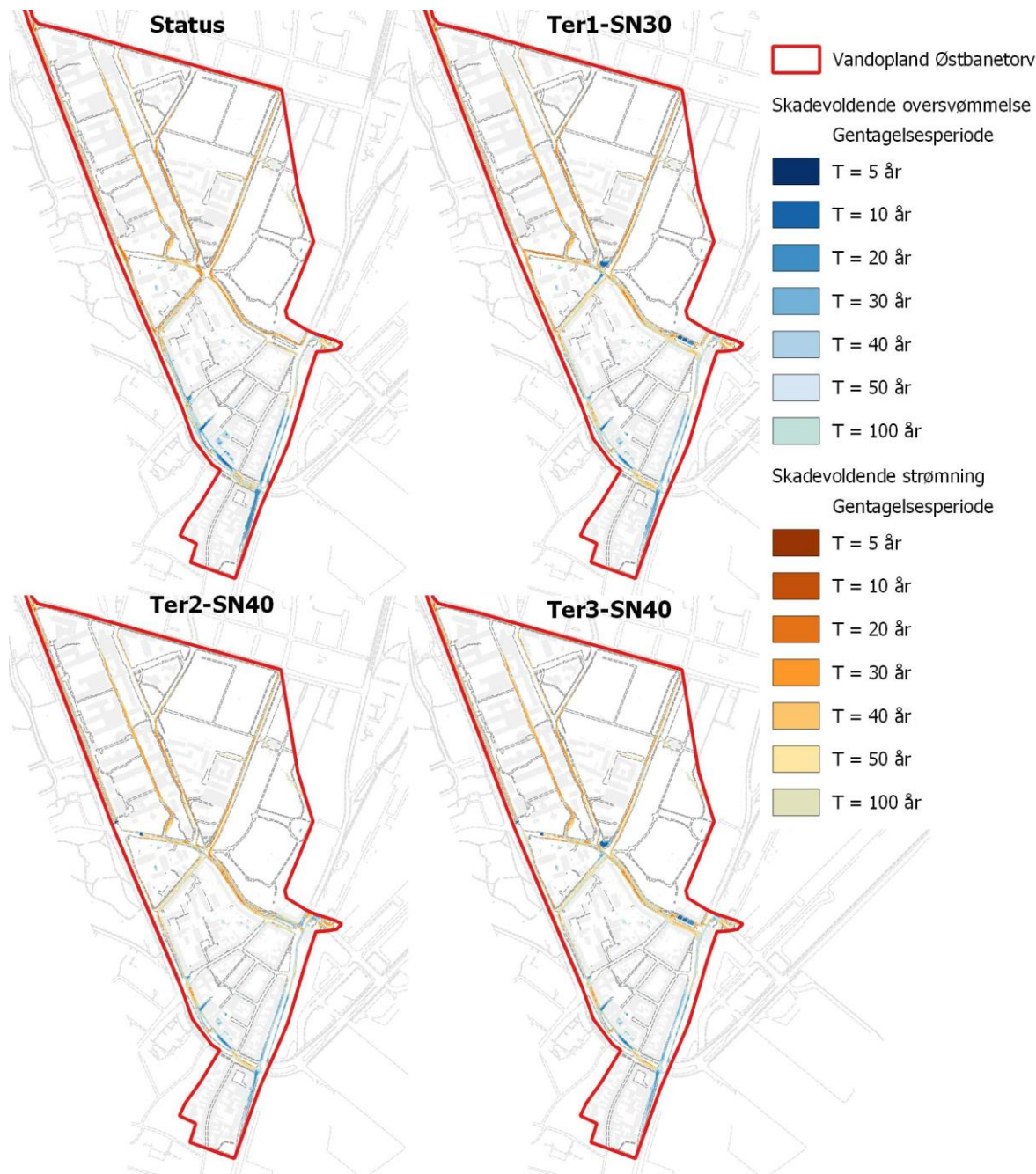
Figur 7-7. Oversvømmelseskort for planscenarier for det sydlige delområde, øverst tv. Status, øverst th. Ter1-SN30, nederst, tv. Ter2-SN40 og nederst th. Ter3-SN40. For den nordlige del er der de samme løsningstiltag i alle planscenarier og derfor samme resulterende oversvømmelser. Oversvømmelseskort findes i stort format i bilag A4, A5 og A6.
