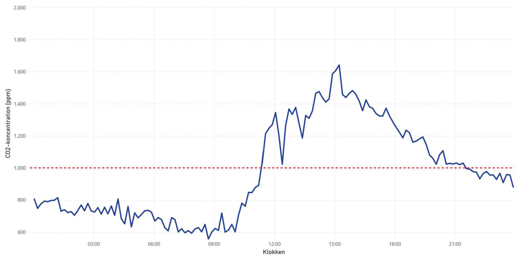
Figur 4.6: Målt CO 2 -koncentration over en typisk dag før tiltagene implementeres. Den røde stiplede linje indikerer Arbejdstilsynets anbefalede niveau af CO 2 -koncentration på 1000 ppm
